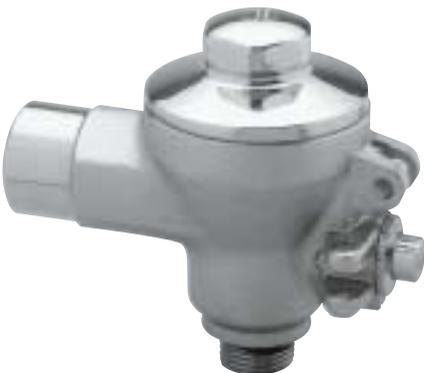
Válvula diseñada con sistema antitraba, con controlador que corta automáticamente una vez finalizado el ciclo de flujo. La unidad básica puede ser operada por medio de un accionador de palanca, de rodilla, botón o cadena. La válvula puede instalarse oculta al muro, dejando a la vista solo el mecanismo de accionamiento.
