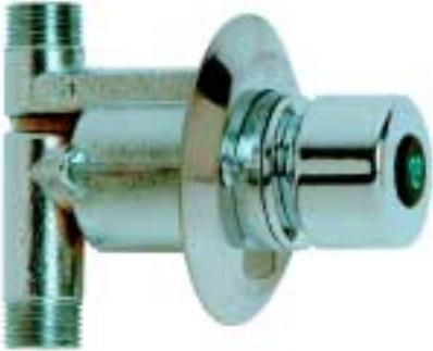
Diseñada para ser empotrada en muro, sustituye a la válvula convencional. Para activar el flujo de agua se presiona y suelta el pulsador frontal. El ciclo puede ser reactivado solamente cuando el pulsador regresa a su posición original. El tiempo se regula mediante un tornillo oculto bajo el logotipo de identificación (agua fría/caliente).
