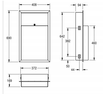
Papelera para montaje empotrado a pared, de acero inoxidable, acabado satinado, de 0,8 mm de espesor, puerta delantera con cerradura estándar Franke, tapa con cierre automático, aprox. 23 litros de capacidad, soporte para bolsa integrado, incluye tornillos de acero inoxidable y tacos.
